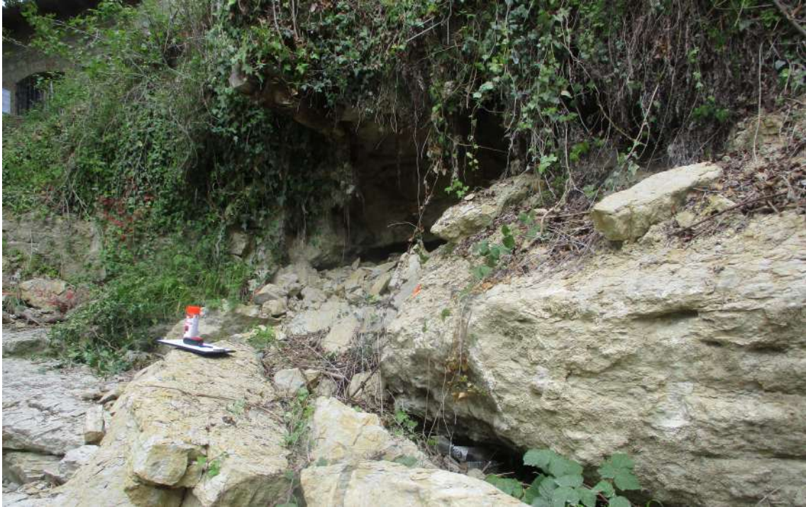
DETALLES ROCAS DESPRENDIDAS. SE PUEDE OBSERVAR EL TAMAÑO POR COMPARACIÓN CON EL BOTE DE PINTURA
